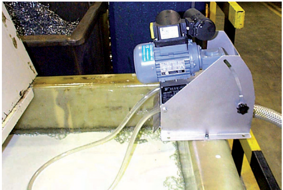
Öl Skimmer Modell 1U an Emulsionsbehälter
